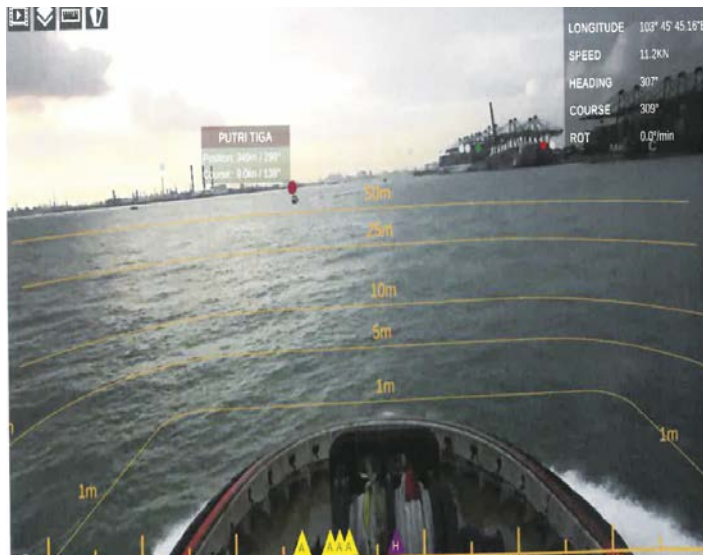
El sistema de Wärtsilä muestra la distancia e información AIS de otros blancos.
