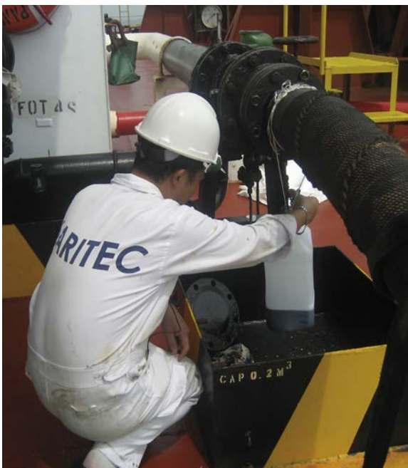
Toma de muestra en el distribuidor (manifold) a bordo del buque.
