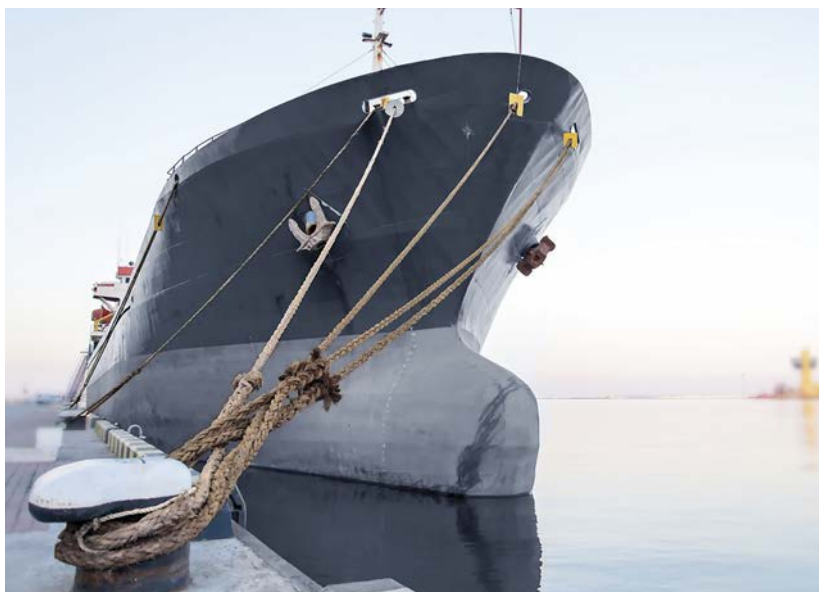
Distribución de largos y traveses a proa de un buque amarrado al costado.
