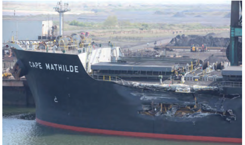
Daños en el costado del Cape Mathilde tras abordarle el Gülnak .
