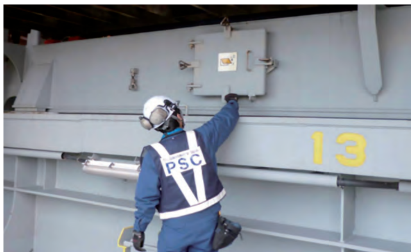
Comprobación del cierre de una escotilla en una inspección de Port State Control.
