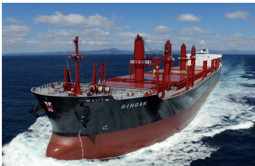
El Singan , proyectado para el transporte de troncos de madera sobre cubierta, es un handysize con una capacidad de 44.150 metros cúbicos / SWIRE BULK.
